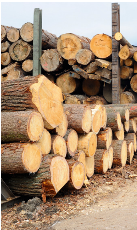
80 % Starkholz: Entrindet wird vorher, das verlängert die Lebensdauer der Sägeblätter
