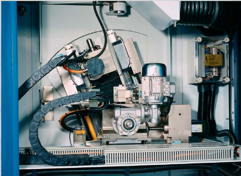
Die Winkelverstellung kann motorisch mittels Touch Screen verstellt werden
