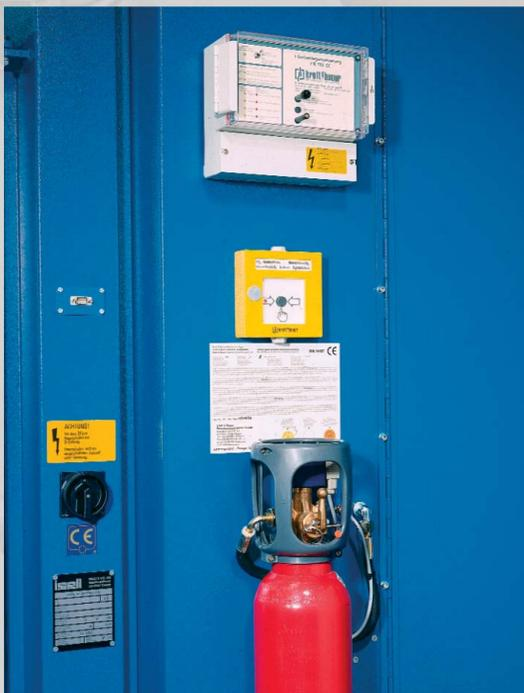
Effiziente CO<sup>2</sup> Brandschutzanlage, wenn die Maschine mit Öl betrieben wird (Option)
