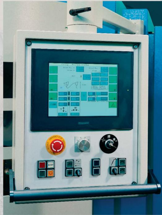
Übersichtliche und bedienungsfreundliche Steuerung. Speichermöglichkeit für die Kreissägen-Parameter
